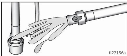
9. Dévisser la crépine d'entrée du tuyau d'aspiration. La placer dans le seau à déchets.
