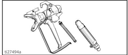
2. Retirer l'ensemble buse de pulvérisation et garde-buse et le nettoyer avec de l'eau ou du produit de rinçage et une brosse.
