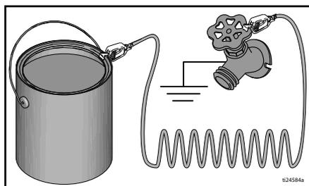
**Pour maintenir la continuité électrique lors du rinçage du pulvérisateur ou du relâchement de la pression** maintenir une partie métallique du pistolet pulvérisateur fermement sur le côté d'un seau métallique relié à la terre, puis appuyer sur la gâchette du pistolet.
