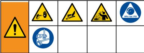
Cet équipement reste sous pression tant que la décompression n'a pas été effectuée manuellement. Pour éviter de sérieuses blessures provoquées par du produit sous pression, comme des injections sous-cutanées ou des projections de produit, appliquer la **Procédure de décompression** à chaque fois que le pulvérisateur est arrêté et avant le nettoyage ou la vérification du pulvérisateur et avant que l'équipement ne fasse l'objet d'une réparation.
