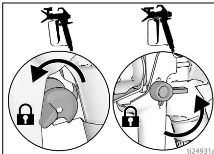
14. Mettre la vanne d'amorçage/pulvérisation en position d'AMORÇAGE.
