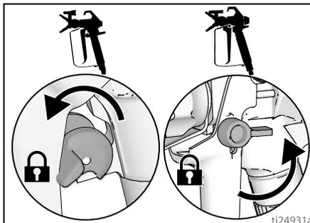
15. Mettre la vanne d'amorçage/pulvérisation en position d'AMORÇAGE.
