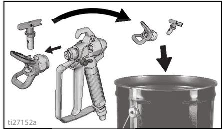
3. Essuyer la peinture se trouvant sur l'extérieur du pistolet à l'aide d'un chiffon doux mouillé à l'eau ou à l'aide d'un liquide de rinçage.
