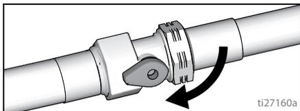
13. Faire circuler l'eau à travers le pulvérisateur et la laisser s'écouler dans le seau à déchets pendant 20 secondes.
