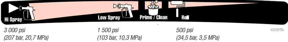
Pour sélectionner la fonction, mettre le symbole figurant sur le bouton de régulation de la pression en face de l'indicateur de réglage situé sur le pulvérisateur.
