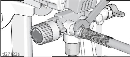
2. Brancher l'autre extrémité du flexible sur le pistolet.
