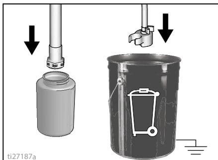
3. Sur les modèles à trémie, verser le fluide Pump Armor dans la trémie et mettre le tuyau de vidange dans le seau à déchets.
