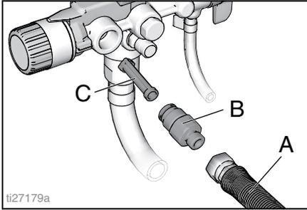
5. Vérifier la présence de débris dans le filtre pour fluide InstaClean (C). Si nécessaire, nettoyer le filtre avec de l'eau ou du solvant de rinçage et une brosse douce.
