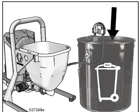
6. Verser du liquide de rinçage dans la trémie. Utiliser de l'eau pour une peinture à base d'eau et de l'essence minérale pour une peinture à l'huile.
