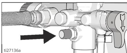
6. Placer l'indicateur de réglage en face du réglage d'amorçage/nettoyage figurant sur le bouton de régulation de la pression.
