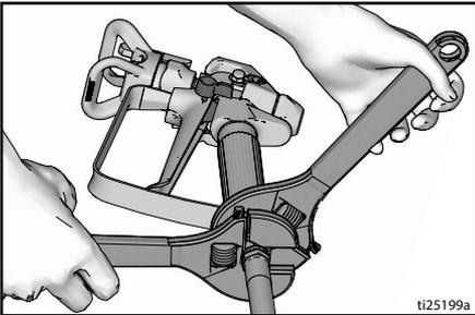
3. Utiliser des clés pour le serrer fermement. Si le tuyau est déjà branché, veiller à ce que les raccords soient bien serrés.
