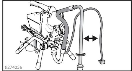
5. Placer le seau à déchets vide et le seau de rinçage l'un à côté de l'autre.
