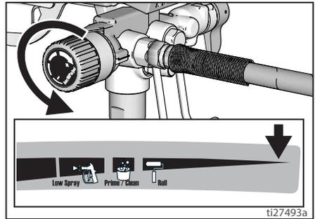
4. Mettre le tuyau de vidange dans un seau et placer la vanne d'amorçage/pulvérisation en position AMORÇAGE (vidange) pour relâcher la pression.
