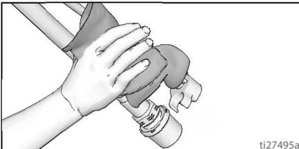
4. Débrancher le tuyau de vidange (petit) du tuyau d'aspiration (gros).
