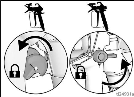
19. Mettre la vanne d'amorçage/pulvérisation en position d'AMORÇAGE.
