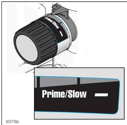
8. Mettre la vanne d'amorçage/pulvérisation en position d'AMORÇAGE.
