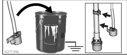
**REMARQUE :** lorsque le moteur s'arrête, le pulvérisateur est prêt à peindre. Si le moteur continue à tourner, le pulvérisateur n'est pas amorcé correctement. Répéter l'opération de **Remplissage de la pompe** et l'opération de **Remplissage du pistolet**.
