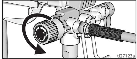
7. Au moment du déballage du pulvérisateur avant la première utilisation, retirer les matériaux d'emballage de la crépine d'entrée. Après un stockage de longue durée, vérifier que la crépine d'entrée n'est pas obstruée et ne contient pas de débris.
