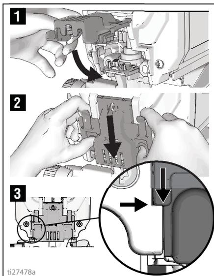
**REMARQUE :** la porte doit être complètement fermée et verrouillée avant que le pulvérisateur puisse fonctionner.
