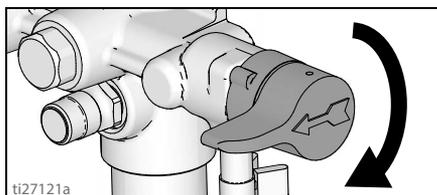
L'autre type de vanne d'amorçage/pulvérisation est doté d'un levier qui peut être mis en position AMORÇAGE ou PULVÉRISATION.
